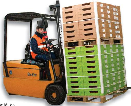
Le plateau sérénité® garantit la sécurité et l'efficacité de l'empilage des plateaux fruits et légumes. Il assure ainsi la stabilité des charges, quel que soit le fabricant en Europe. Pour cela, il exige le respect des spécifications européennes harmonisées de dimensions et de dispositif de gerbage (Common footprint).
